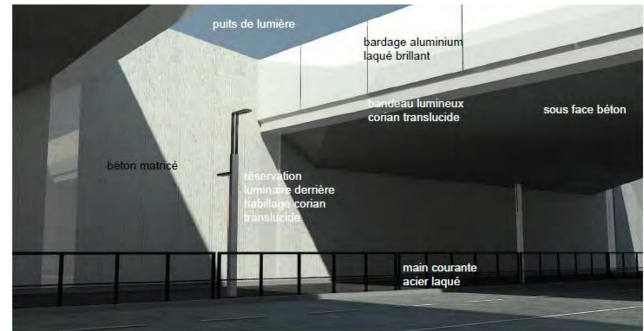
Figure 30 : Vue architecturale sous l'ouvrage à hauteur d'homme – source RFF-SNCF.
