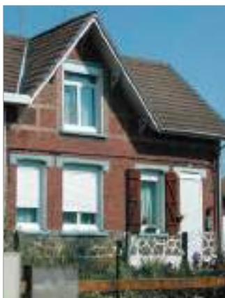
Des appuis et des linteaux béton «standardisés». Des couvertures tuiles.
