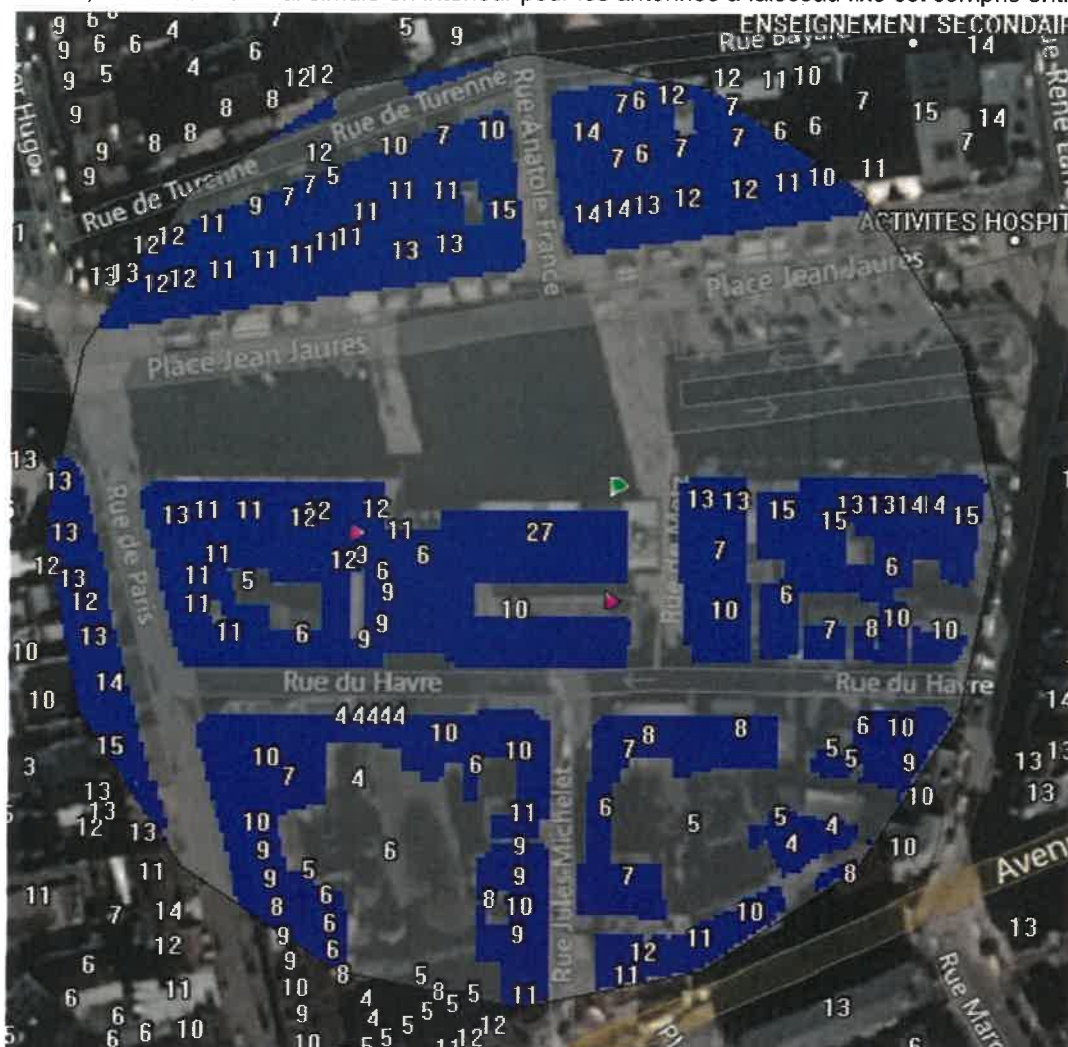
Fond de carte (photo aérienne), source : bing. Logiciel de simulation Cellerity, éditeur Orange Labs
