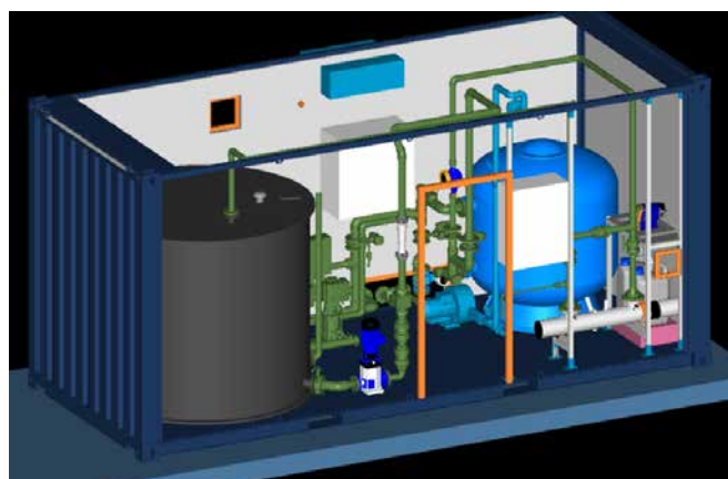
Schéma de principe d'une unité de REUT STEP de Mazingarbe et Loison sous Lens
